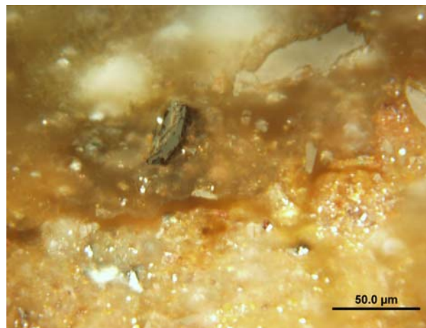
Obr. 14 Fragment částečně humifikovaného pletiva, metatuf, 200° C, 1 den
