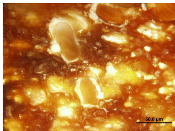
Obr. 13 Částečně deformované pletivo, metatuf, 140° C, 1 týden
