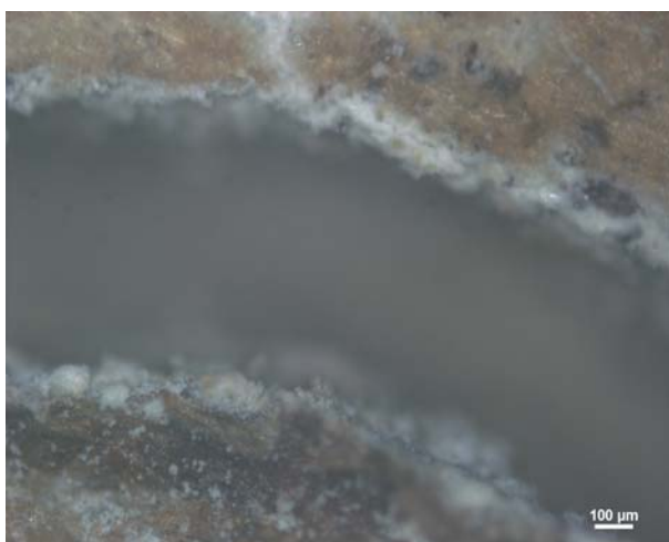
Obr.B) Pohled na rozhraní kaverny a stromu po alteraci 1 týdne (metakaolin – metatuf).
