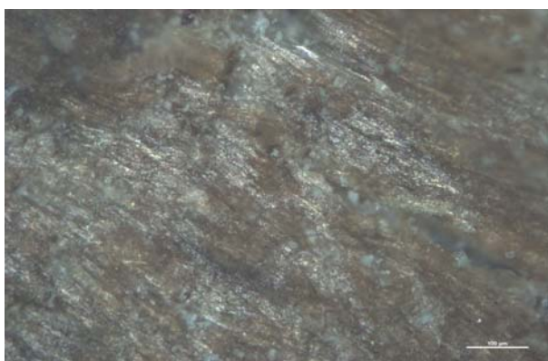
Obr. A) Pohled na průřez dřevní hmoty po alteraci 1 týdne při 140° C (metakaolin – metatuf).
