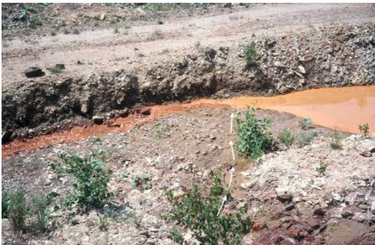
Obr. 2 Slévající se potůčky důlních vod o různém pH a barvě sraženin v lomu Lomnice. Zprava přitéká kyselá voda (pH = 3,7) se sraženinami schwertmannitu, vpředu ve směru šipek alkalická voda (pH = 8,2). Po soutoku se pH mění na 7,3 a dochází ke srážení ferrihydritu. Foto E. Murad 2002
